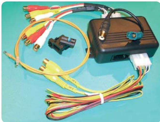
Компания TEC Electronics производит целый ассортимент высокотехнологичных устройств, призванных помочь инсталляторам оптимально решить сложные проблемы установки и сопряжения охранного и мультимедийного оборудования в современных автомобилях, оборудованных цифровыми шинами различного типа, в том числе шинами CAN<sup>1</sup> и MOST.
