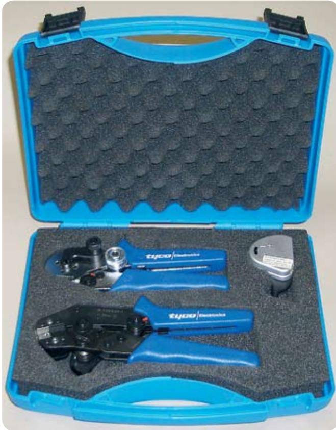
Инструмент для работы с оптическим кабелем
