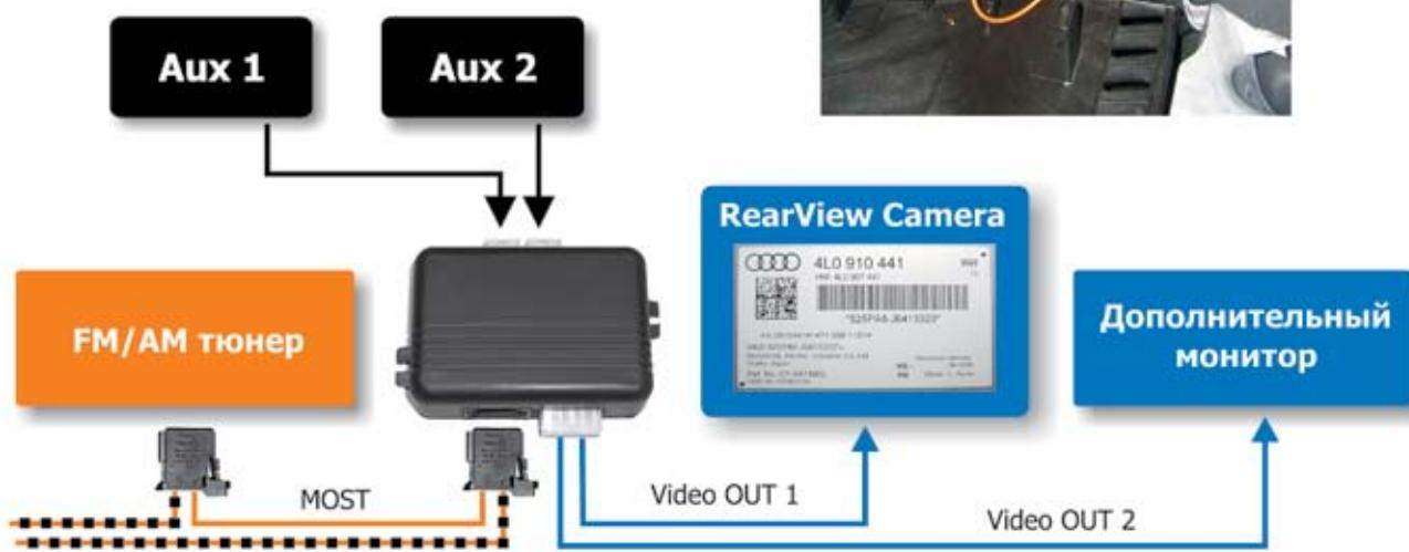
Схема подключения и размещение модуля AutoMOST-vA (Audi)
