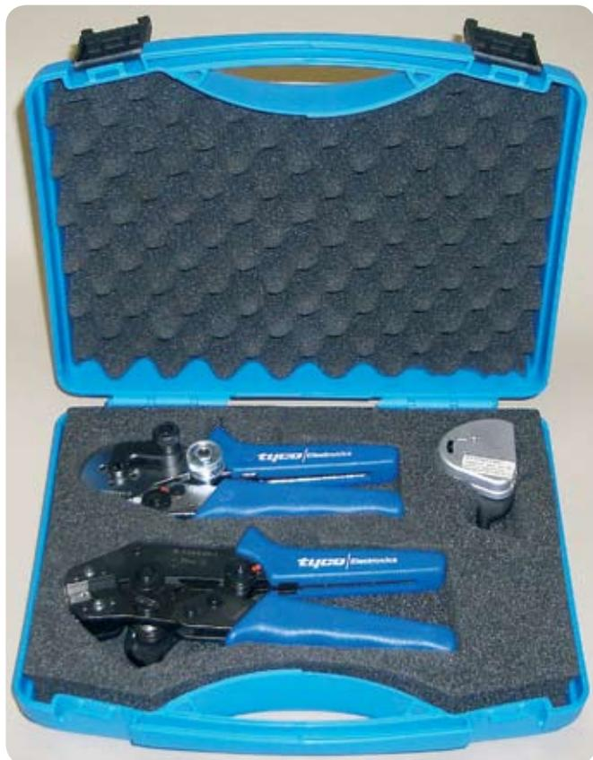
Инструмент для работы с оптическим кабелем
