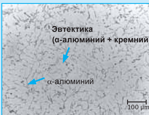
в) доэвтектический с улучшенной структурой
