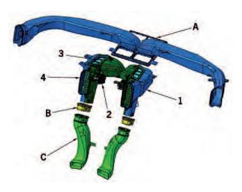
Воздух на все дефлекторы задней части (включая стойку В) 4-зонного климат-контроля подается через задний блок отопителя (колесная арка слева). Функция и конструкция заднего климат-контроля по существу не изменились.
